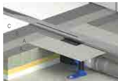
12. A: Хидроизолация B: Лепило за плочки C: Настилка от плочки
